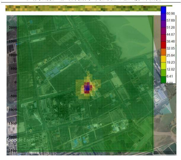
图 5.2-6 TSP 24h 平均最大浓度等值线图 单位: μg/m³
